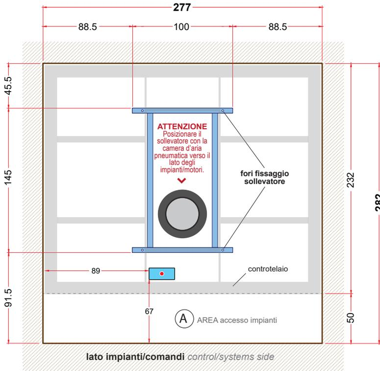
PROVVEDERE AL FISSAGGIO A TERRA DEL SOLLEVATORE SOLO DOPO AVER FATTO LA PROVA DI ESCURSIONE CON IL SOLO CONTROTELAIO.
