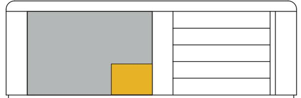
Provvedere alla foratura del fondale (all'interno dell'area indicata a lato) per il passaggio del cavo, ed eseguire collegamento elettrico alla centralina.
